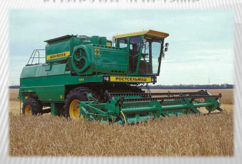
Зерноуборочный комбайн Дон-1500Б состоит из жатки наклонной камеры, молотилки, бункера, копнителя, капота или измельчителя соломы, двигателя, силовой передачи, ходовой системы, гидравлической системы, кабины, органов управления и электронной системы контроля технологического процесса и состояния агрегатов. Ширина молотилки 1,5 м.
