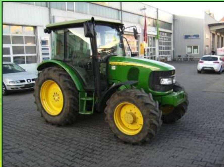
Модель **5720** имеет рамную конструкцию, обеспечивающую защиту агрегатов трактора от перегрузок. На трактор установлен четырехцилиндровый двигатель «**John Deere PowerTech**» объемом 4,5 л, который обеспечивает запас крутящего момента 34%.
