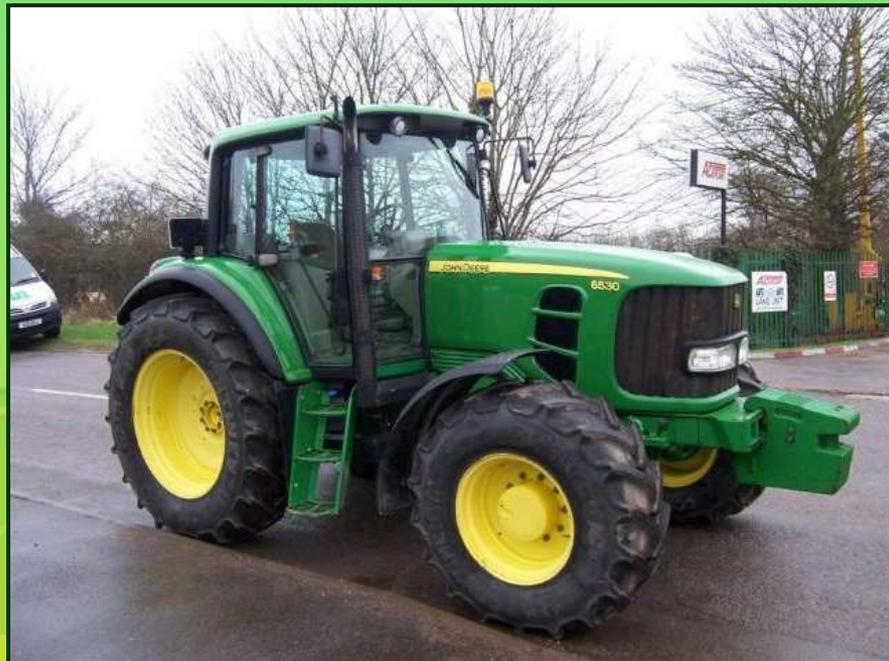
**Модель 6530** оснащена двигателем «**John Deere PowerTech Plus**» с системой «IPM» и обладает дополнительным приростом мощности 8 л.с. на высоконагруженных полевых работах и 25 л.с. на транспортных работах и при работе с орудиями требующие приводом от ВОМ.
