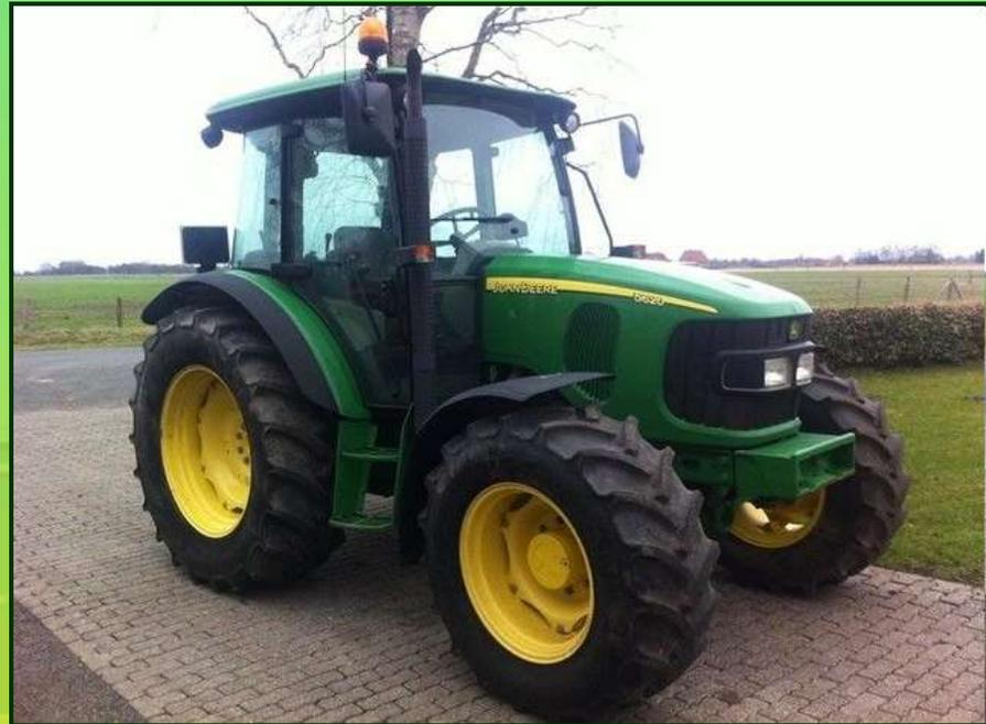
**Рамная конструкция** трактора **Джон Дир 5620** обеспечивает защиту агрегатов от перегрузок при работе с фронтальными погрузчиками и навесными орудиями. Модель оснащена 4-х цилиндровым двигателем «**John Deere PowerTech**» объемом 4,5 л.
