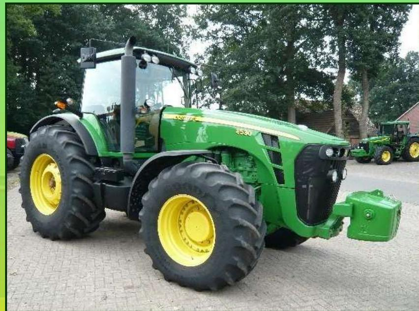
На трактор **Джон Дир 8530** установлен новый двигатель «**John Deere PowerTech Plus**» объемом 9,0 л. Двигателя имеют аккумуляторную топливную систему впрыска **Common rail** фирмы «**Denso**». Чтобы обеспечить высокую производительность в двигателе объемом 9,0 л используется турбокомпрессор системы «**VGT**» с изменяемой геометрией лопаток.
